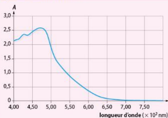
DOC 1 Spectre d'absorption d'une solution aqueuse diluée de diiode
